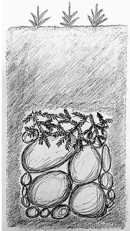
Havainnekuva kiviojan rakenteesta. Piirros Eeva Puustjärvi.
